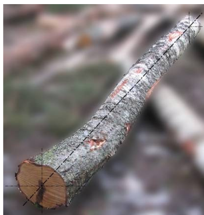
Joonis 8. Liitkõver e mitmesuunalise kõverusega kase nott.
